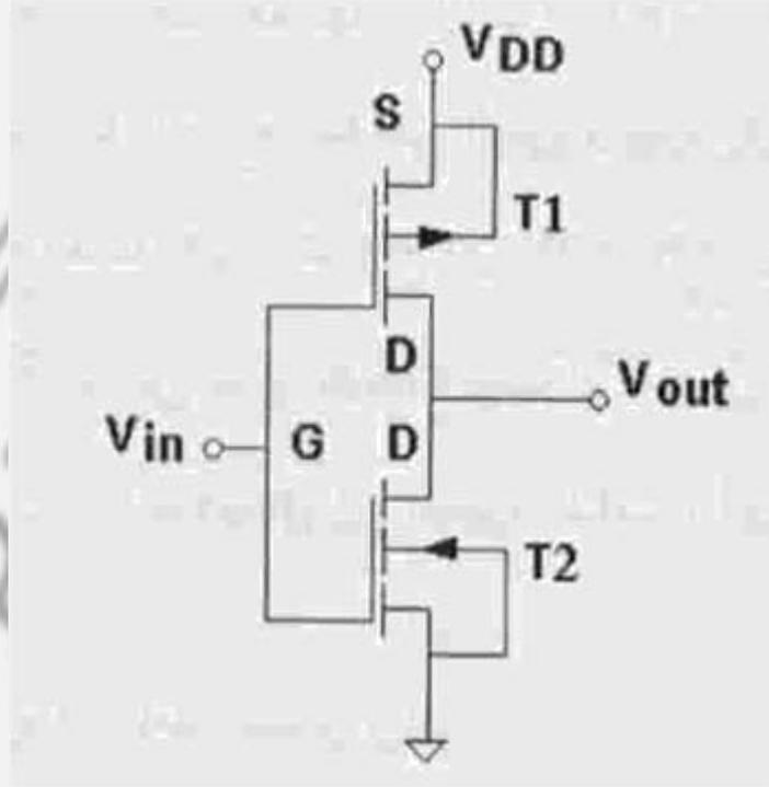
عندما يكون جهد الدخل **H** يكون **T2** في حالة **on** و **T1** في حالة **off** وجهد الخرج يساوي  $V_{DS(on)}$  للترانزستور **T2** وهذا الجهد يساوي تقريبا " **0.05V** وهو يكافئ **Low**, أما عندما يكون الدخل **Low** فان **T1** يكون في حالة **on** و **T2** في حالة **off** و جهد الخرج  $V_{out}=V_{DD}$  وهذا الجهد يكافئ **High** والدارة تعمل كعاكس .
