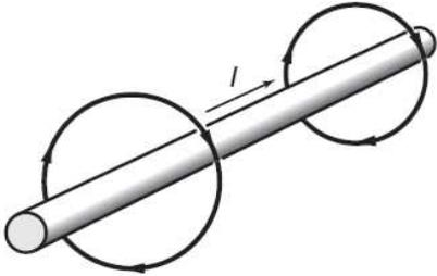
63. يسري تيار اصطلاحي في سلك، كما هو موضح في الشكل 5-28. ارسم قطعة السلك في دفترك، ثم ارسم خطوط المجال المغناطيسي الناشئ عن مرور التيار في السلك.
