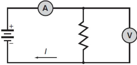
12. أضف فولتметр إلى الرسم التخطيطي للدائرة الكهربائية في المسألة السابقة لقياس فرق الجهد بين طرفي المقاومين، ثم أعد حلها.
