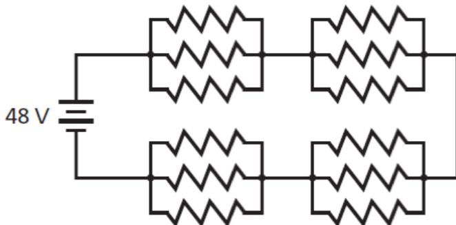
85. تطبيق المفاهيم صمم دائرة كهربائية يمكنها إضاءة 12 مصباح متماثلاً، بكامل شدتها الضوئية الصحيحة بواسطة بطارية جهدها 48 V، لكل حالة مما يلي:
