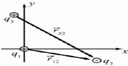
1.51 توجد ثلاث شحنات ثابتة في منطقة حيز ثنائي الأبعاد، +1.00 mC عند (0,0)، -2.00 mC عند (17.0 mm, -5.00 mm)، و +3.00 mC عند (-2.00 mm, 11.0 mm). ما مقدار محصلة القوى المؤثرة في الشحنة -2.00-mC؟
