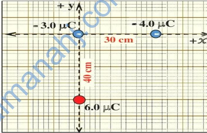
شحنتان كهربائيتان نقطيتان وضعتا كما في الشكل المجاور ، اعتماداً على الشكل و البيانات التي عليه احسب مقدار القوة الكهربائية المحصلة المؤثرة في الشحنة (  $-3.0 \mu\text{C}$  ) وحدد اتجاهها على الرسم .
