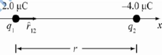
1.44 تقع شحنة مقدارها  $-4.00 \mu\text{C}$  على مسافة 20.0 cm بين شحنة مقدارها  $2.00 \mu\text{C}$  على المحور x. ما مقدار القوة المؤثرة في الشحنة  $-4.00 \mu\text{C}$ ؟
