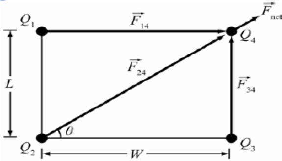
1.47\* وُضعت أربع شحنات متباعدة  $Q$  على الزوايا الأربع لمستطيل محيطه  $2.00 \text{ m}$  في  $3.00 \text{ m}$  إذا كانت  $Q = 32.0 \mu\text{C}$ . فما مقدار القوة الكهروستاتيكية المؤثرة في أي شحنة من الشحنات؟
