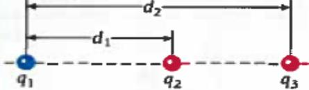
قيم الشحنت هي  $q_1 = -8.10 \mu\text{C}$  و  $q_2 = 2.16 \mu\text{C}$  و  $q_3 = 2.16 \text{ pC}$ . والمسافة بين  $q_1$  و  $q_2$  هي  $d_1 = 1.71 \text{ m}$ . والمسافة بين  $q_1$  و  $q_3$  هي  $d_2 = 2.62 \text{ m}$ . ما مقدار القوة الكهروستاتيكية الكلية التي تبذلها الشحنتان  $q_1$  و  $q_2$  على  $q_3$ ؟
