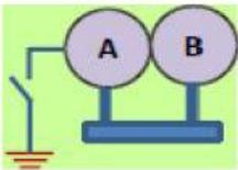
3 - حدد بأربع خطوات يمكنك أن تكسب الموصلان في الشكل المجاور نفس المقدار والنوع من الشحنات الكهربائية دون لمسهما؟
