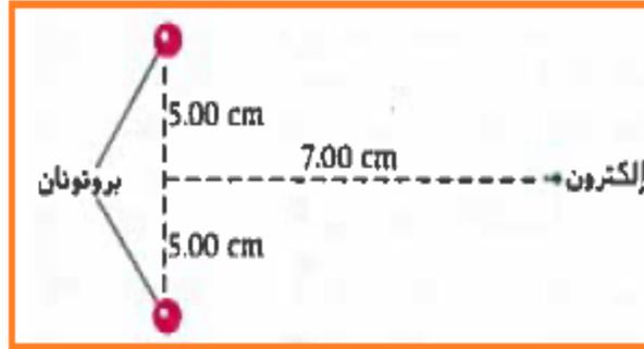
1.50 أوجد مقدار القوة الكهروستاتيكية واتجاهها المؤثرة في الإلكترون الموضح في الشكل.
