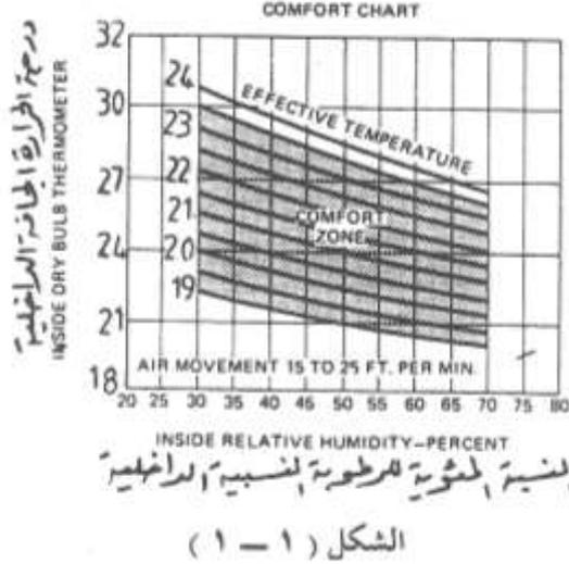
وتجدر الإشارة إلى أن حركة الهواء من الأشياء التي تساعد على الراحة حيث أن سرعة الهواء المرغوبة يجب أن تتراوح ما بين (4.5 : 7.5 m/min) . ومن الخبرة العملية تختار درجة الحرارة الجافة الداخلية ما بين (18 °C : 26 °C) وتختار الرطوبة النسبية ما بين (30% : 70%) .
