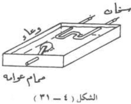
ووحدة الترطيب Humidifier تتكون من وعاء يتم التحكم في ملئه بواسطة صمام عوامه موصل بالمصدر العمومي للماء ويوجد بداخل هذا الوعاء سخان HU مغمور في الماء فعند عمله يتبخر الماء في الهواء فتزداد نسبة الرطوبة بالجو ، والشكل ( ٤ - ٣١ ) يبين مخطط توضيحي لمبخر الوعاء .
