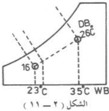
الإجابة:- يلاحظ النسبة بين الهواء الراجع والهواء الخارجي تساوي 1:4 لذلك نقوم بتوقيع نقطة الهواء الراجع والهواء الخارجي على الخريطة السيكمومترية ثم نقسم الخط الواصل على 5 وتكون نقطة المخلوط هي النقطة التي بعد قسم واحد من الهواء الراجع عندها فإن :
