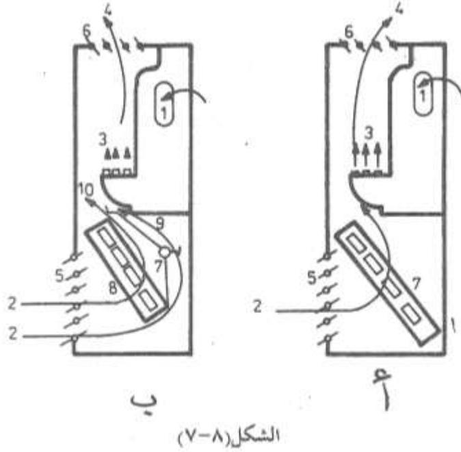
حيث تدخل كمية من الهواء الابتدائي القادم من وحدة مناولة الهواء المركزية داخل غرفة في الوحدة الطرفية الحثية للتقليل من الصوت المصاحب لهذا الهواء ثم يدفع هذا الهواء ذات الضغط العالي خلال مجموعة من الفواني فيعمل هذا الهواء ذات السرعة العالية علي حث الهواء الساكن في الغرفة في الدخول إلي الوحدة الطرفية ويصل حجم الهواء الداخل من الغرفة بالحث ست مرات قدر حجم الهواء المبدئي.
