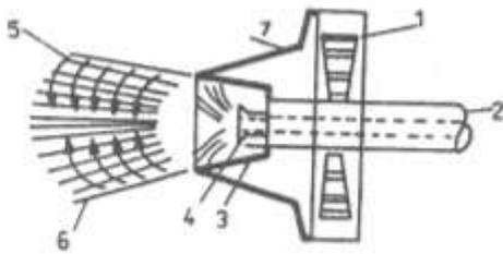
هو خلط الزيت مع البخار المضغوط عند ضغط 7 : 14 bar
