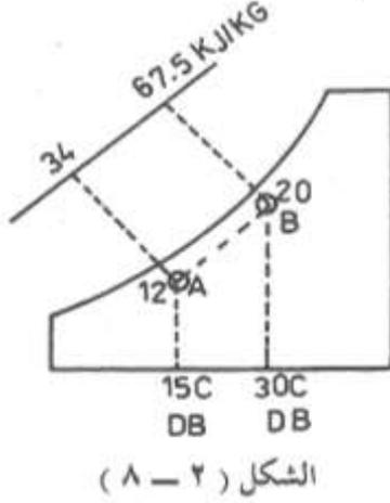
يمكن تحديد نقطة الدخول B والتي لها درجة حرارة جافة  $30^\circ C$  والرطوبة  $20^\circ C$  وكذلك تحديد نقطة الخروج A والتي لها درجة حرارة جافة  $15^\circ C$  ودرجة حرارة رطبة  $12^\circ C$  على الخريطة السيكمومترية كما بالشكل ( ٢ - ٨ ) وبالتالي فإن :
