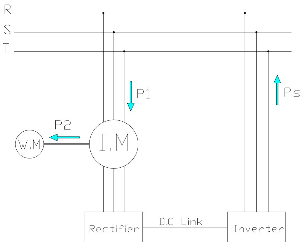
نظام قيادة شيربيوس لإعادة طاقة الانزلاق للشبكة الكهربائية باستخدام محواري تبديل الكترونية
