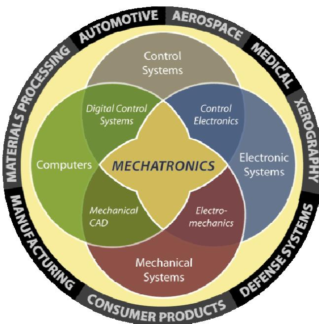
أختلف التعريف الهندسي للميكاترونكس منذ أن بدأت وحتى يومنا هذا وذلك بسبب التقدم المستمر لها بشكل يومي، فالميكاترونكس هو العلم الهندسي الذي يربط بين الهندسة الميكانيكية والهندسة الكهربائية وهندسة الحاسوب وأنظمة التحكم.
