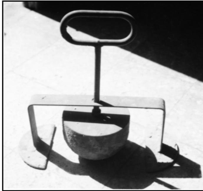
شكل (٧-٩) جهاز كرة كيلي لقياس القوام.
