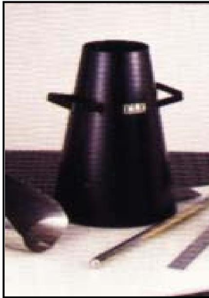
شكل (٧-٢) قالب اختبار الهبوط وقضيب الدمك.
