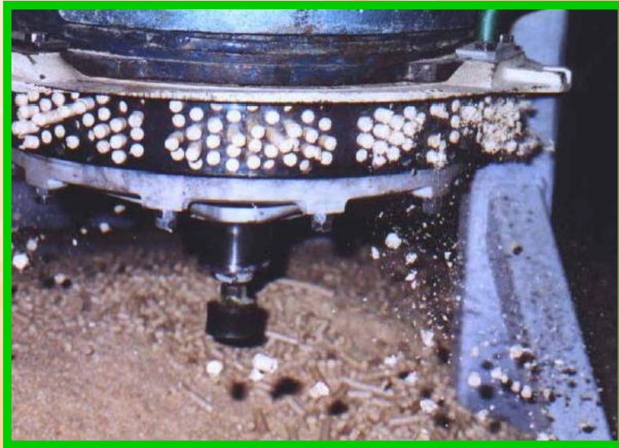
ماكينة القولية ذات شكل يوضح خروج نواتج عملية القولية من القالب المسطح
