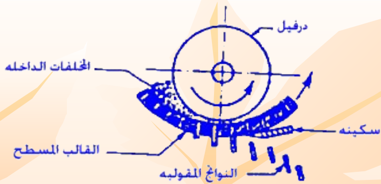
قالب مسطح لعملية القولية
