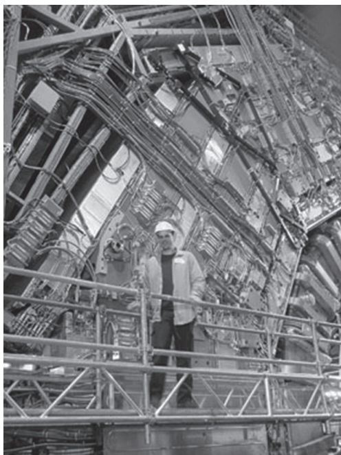
شكل ١٣-٢: زميلي جيلاد بيريز أمام أحد أجزاء كاشف الميونات المتعدد الطبقات بتجربة «اللولب المركب للميونات». وهذا الجزء هو مَقَرَن المغناطيس الارتدادي.
