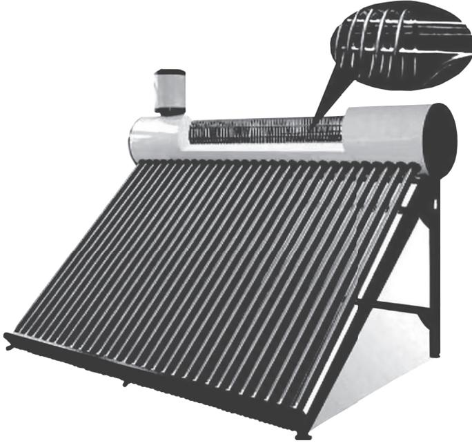
شكل ١١-١٦: سخان ماء شمسي ذو ملفات تبادل حراري مضغوطة: يجري الماء الساخن القابل للاستخدام فقط في ملف التبادل الحراري داخل الخزان المعزول؛ ومن ثم يمكن ضغطه ولن يتلوث بسبب نظام التجميع الحراري. وتوضح الصورة الدعائية بعض تفاصيل ملف التبادل الحراري.
