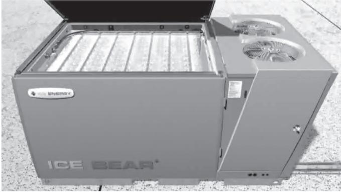
شكل ١٢-٣: نظام تخزين الطاقة آيس بير: خزان معزول مملوء بالماء والعديد من ملفات التبادل الحراري النحاسية. في أثناء الليل، يستخدم المبرد كهرباء رخيصة ويبرد الهواء ليحول الماء إلى ثلج، وكما أوضحنا في الفصل السادس، كلما قلت درجة الحرارة المحيطة، زاد معامل الأداء؛ لذا لصنع قدر محدد من الثلج أثناء الليل، تكون تكلفة الكهرباء أقل بكثير مما هي عليها في وقت النهار الحار. الصورة معروضة بإذن شركة آيس إنرجي المحدودة.
