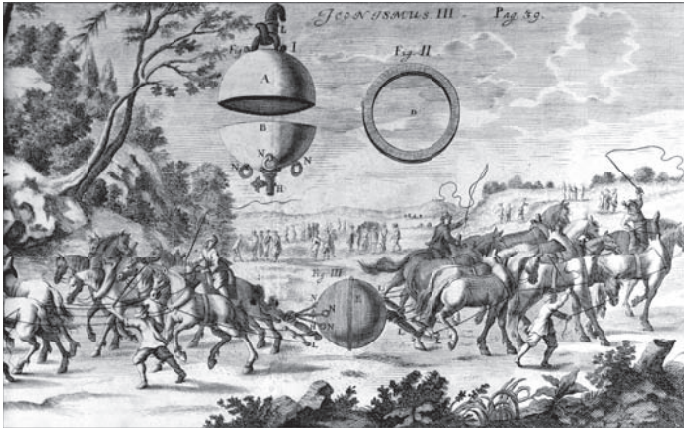
شكل ٤-٣: تجربة أوتو فون جيريكه الاستعراضية التي أثبت فيها أن فريقين من الخيول لا يستطيعان فصل نصفي كرة مجوفة تم تفريغها من الهواء، في إشارة إلى تأثير الضغط الجوي. الصورة من كتاب جاسبر شوت «الفضول التقني» (نورمبرج ١٦٦٤). 1
