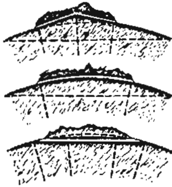
شكل ٤٥ : ثلاث طرق لحفر الانفاق التى تنتشر الجبال .
